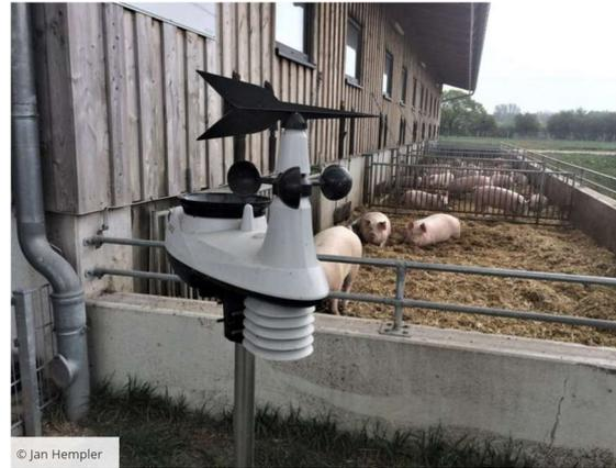
Sensortafel zur Erfassung des Stallklimas und Wetterstation zur Messung des Klimas im Außenbereich
